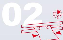
Durch Betätigen des Fußtasters wird der Vakuum-Schweißprozess durch Schließen der Schweißstempel gestartet: Die Vakuumpumpe schaltet ein und saugt die Luft um das Produkt herum ab.
