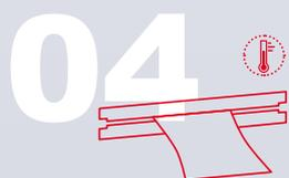
Die Schweißstempel schließen vollständig und verschweißen das Verpackungsmaterial. Nach dem Schweißvorgang öffnen die Schweißstempel automatisch und die Maschine ist sofort für den nächsten Durchlauf startbereit.
